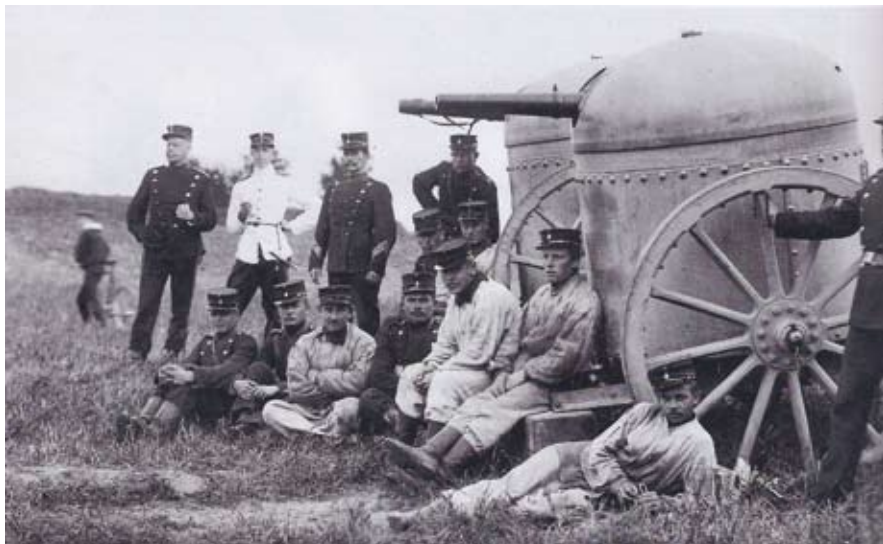
Der er både mange fotografier og gode kort i den nye bog om Københavns Befæstning. Fotografiet viser fæstningsartillerister med mobile pansertårne med 53 mm kanon. Fæstningsartilleriet rådede over seks tårne, der primært var tænkt anvendt nedgravet i armeringsbatterier.
